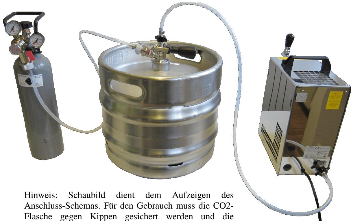
Hinweis: Schaubild dient dem Aufzeigen des Anschluss-Schemas. Für den Gebrauch muss die CO2-Flasche gegen Kippen gesichert werden und die Bierleitung sollte steigend verlegt werden.
