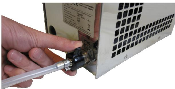
Schrauben Sie den Bierschlauch (5/8"-Verschraubung) an die Zapfanlage/Durchlaufkühler an und ziehen Sie die Flügelmutter per Hand fest. Als Alternative zur Zapfanlage verwenden Sie eine flexible Zapfpistole.
