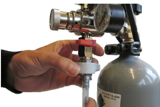
Schrauben Sie den CO2-Schlauch unten an den Druckminderer (3/4"-Verschraubung) und ziehen Sie die Flügelmutter fest per Hand an. Schließen Sie den Absperrhahn.
