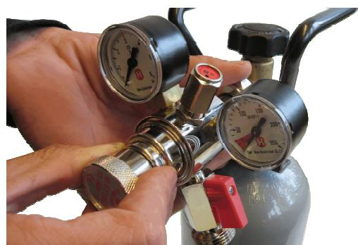
Schrauben Sie den Druckminderer an die CO2-Flasche und ziehen Sie die Verschraubung fest an mit einem Schraubenschlüssel.
